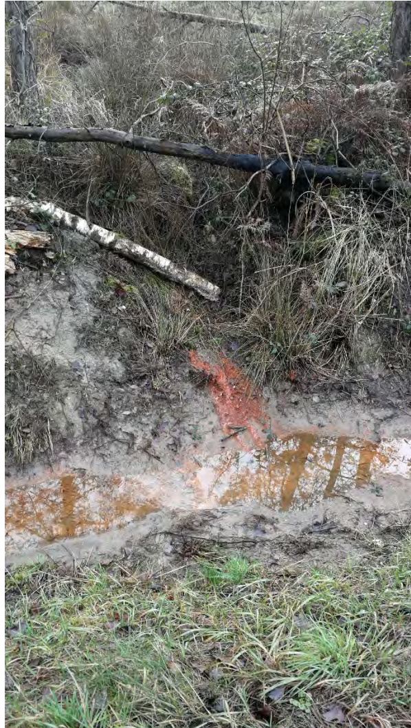
Abbildung 52: Randgraben an der Eichenallee mit Eisenoxid-/hydroxidausfällungen im Grabenwasser sowie punktuell starke Ausfällungen wenige Zentimeter oberhalb des Wasserspiegels im Graben, die vermutlich durch aus Richtung der Verfüllung zutretendes stark Eisenhaltiges Sickerwasser verursacht wurden. (Datum der Aufnahme: 23. Januar 2020) 88
