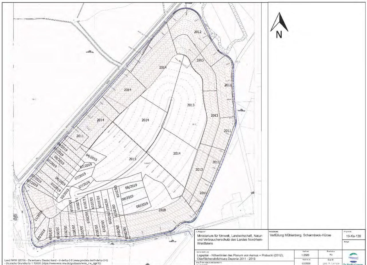
Abbildung 27: Zeitpunkte der fertiggestellten Bauabschnitte der Oberflächenabdichtung mit Höhenlinien; Grundlage: Asmus + Prabucki Ingenieure Beratungsgesellschaft mbH, Plan Nr. AP 1 „Mühlenberg Süd, Lageplan OK Planum (Rohbau), vom 18.12.2012 [34].
